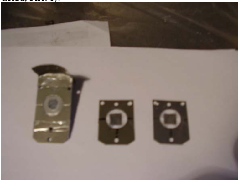
Рис. 3. Слева – источник позитронов, справа – оправки с исследуемыми образцами сталей. Образцы крепились к оправкам тонкой липкой лентой
