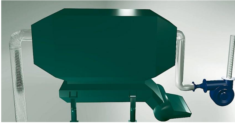
Рис. 3. Подача частиц пыли в виртуальную модель фильтра
